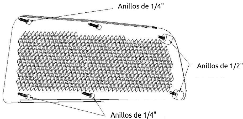
**NOTA:** como un consejo útil de instalación, los espaciadores pueden ser asegurados a la parrilla de entrada con silicón y se deja secar previo a la instalación. Cinta adhesiva también puede usarse para asegurar los espaciadores.
