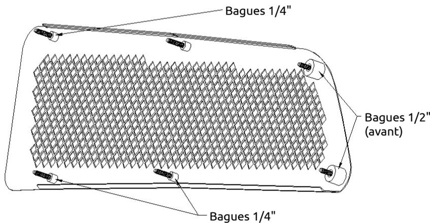
**NOTE:** Conseil pratique d'installation : les bagues peuvent être fixées à la grille de prise d'air avec du silicone qu'on laisse sécher avant l'installation. Vous pouvez aussi fixer les bagues avec du ruban adhésif.
