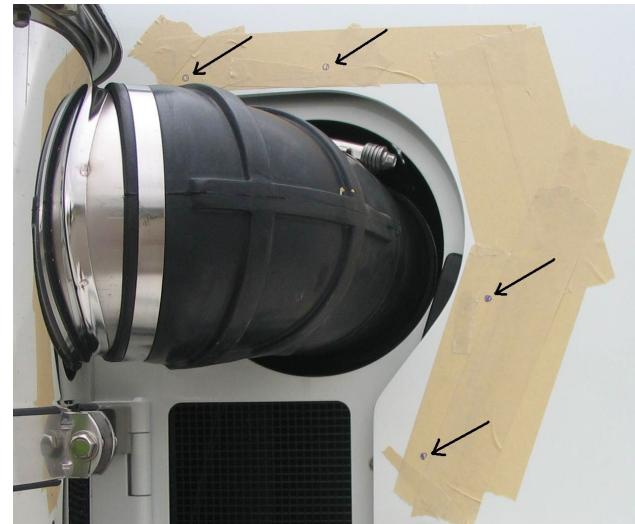
**IMPORTANT:** Avant de percer des trous, vérifiez le dégagement autour des renforts du capot. Le capot a une nervure de renfort à l'intérieur à l'endroit indiqué ici
