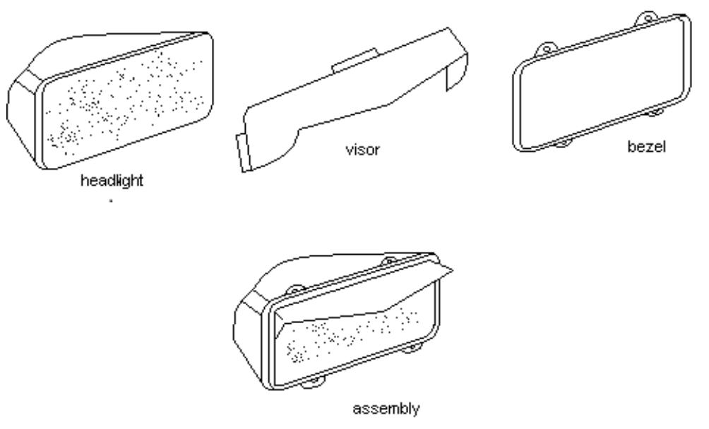
3. Afloje el anillo retenedor de acero inoxidable lo suficiente como para facilitar el sujetado de la pestaña de la visera entre el faro y el anillo retenedor. (Vea el diagrama arriba)
