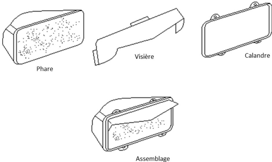
3. Desserrer la bague de retenue en acier inoxydable pour faciliter le serrage de la bordure de la visière entre le phare et la bague de retenue. (Voir schéma ci-dessus)
