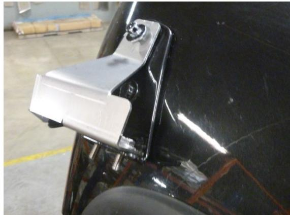
4. Monte el soporte central flojamente en su lugar, con el soporte del pasajero arriba del soporte del piloto, y ambos soportes abajo del soporte OEM (vea la foto abajo).
