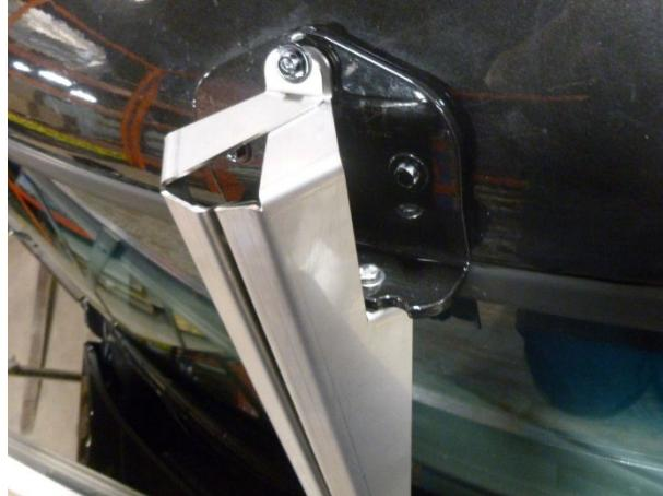
5. Coloque las mitades de visera en el camión con la brida horizontal de MBDU/MBPU bajo los soportes OEM correspondientes.
