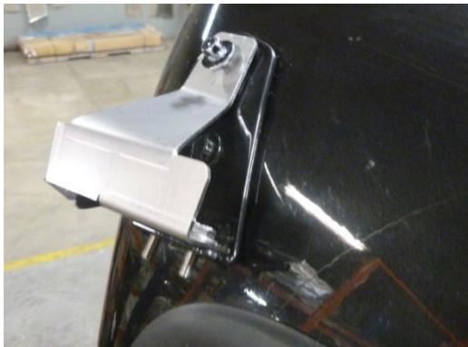
4. Installez les supports centraux en place, en plaçant le support côté passage par-dessus le support côté conducteur, et les deux supports sous le support OEM (voir l'image ci-dessous)
