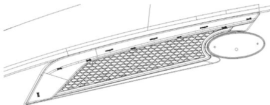
2. Placez du ruban adhésif sur l'arrière du support et installez sommairement le support en place. Il y a trois trous pour fixer la grille d'origine. Les trous de fixation du support ne devraient pas être au même endroit.
