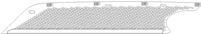
7. Instale el soporte y pruebe en seco la rejilla. Ajuste el soporte de tal forma que la parte trasera de la rejilla se alinee con el contorno del camión. El camión tiene curva por lo que ninguno de los extremos puede montarse a ras. El extremo frontal se cubre con la brida, enfóquese en los extremos medios y traseros.
