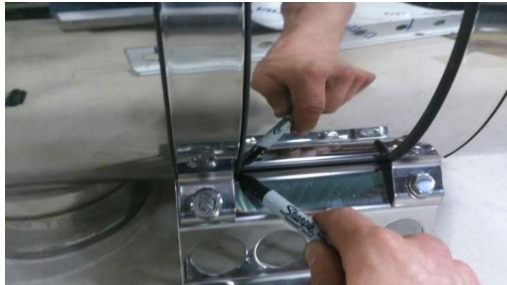
3. Retirez le support et les sangles d'usine . Les boulons polis seront réutilisés pour fixer le nouvel assemblage sur le camion.
