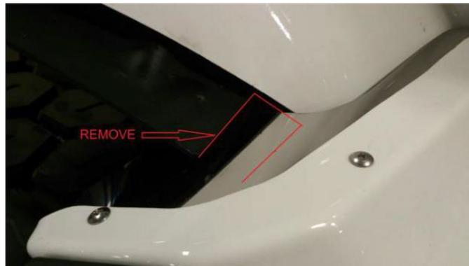
3. Retirez les deux boulons illustrés ci-dessous pour permettre une installation plus facile de l'écran pare-boue.
