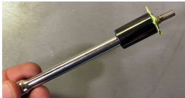
Image 3 – Comment poser les boulons à carrosserie
