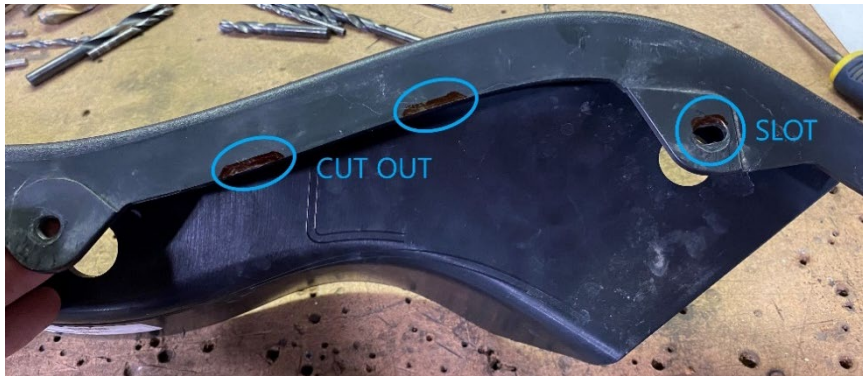
Fig 1: Modifications du panneau OEM (mi-toit – Côté passager).
