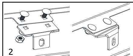
3. Installez le support arrière à la cabine avec les boulons hex 1/4-20 X 1/2" et une rondelle freinée 1/4".
