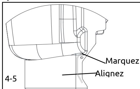
6. Installez la jupe de cabine sur le camion avec les boulons hex 1/4-20 X 3/4" les rondelles plates et les contre-écrous aux endroits indiqués à l'image ci-dessous. Ne pas serrer complètement.
