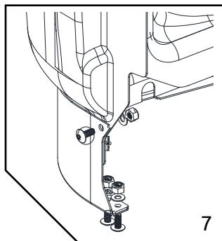
8. De forma completa, apriete el soporte de montaje frontal a la cabina, y la falda al soporte de montaje. Controle el espacio entre la falda y la tapa mientras aprieta.
