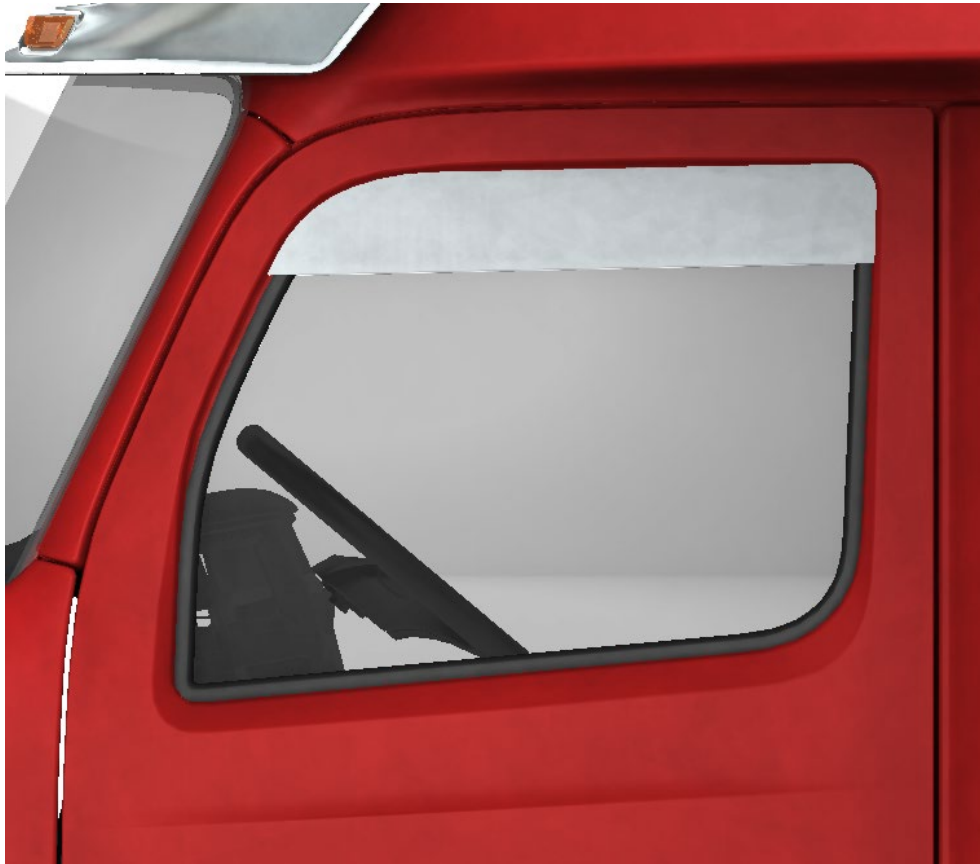
Fig 1: Sombra para Ventana instalada (579 ilustrado)
